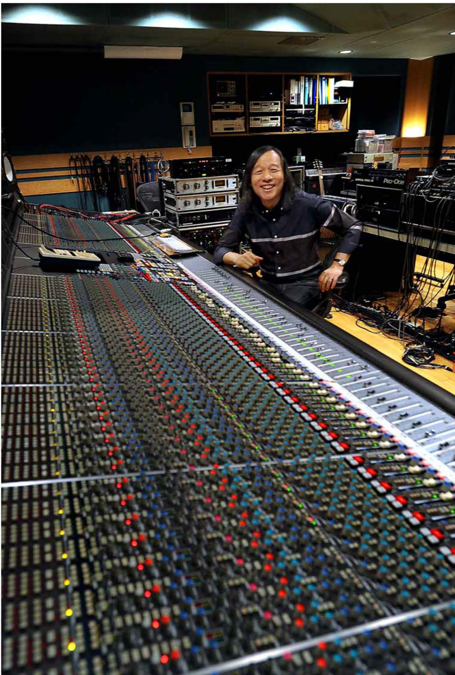
数々の名作を生み出したスタジオで。手前は音を調整するミキシング・コンソールという機材。この機種は国内に数台しかないという。東京港区区
