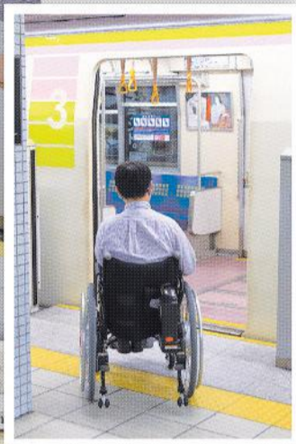
▲ホームと車両の段差をなくし、車椅子の乗降に対応
